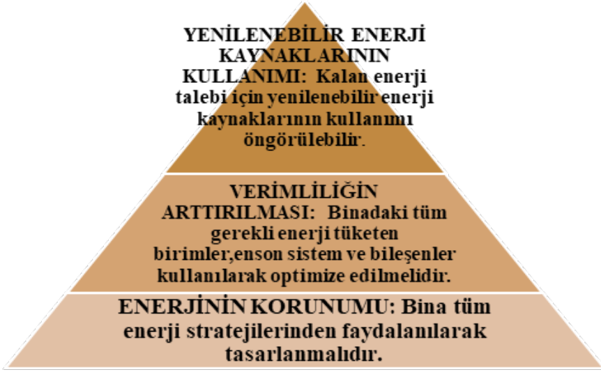
Şekil 1. Düşük Enerjili Bina Tasarımı İçin Enerji Üçgeni[6]
