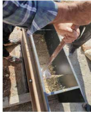
Resim 2.2. Tokmaklama yöntemi (Öztürk, 2020)
