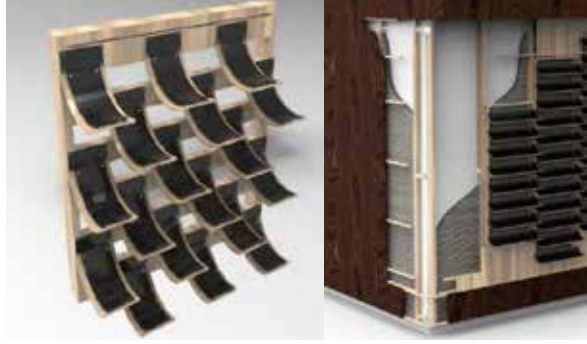
Şekil 25. Cephe kaplaması ve güneş kırıcı sistem olarak BIPV uyarlmalı lamel entegrasyonuna örnek(Solda) [44]
