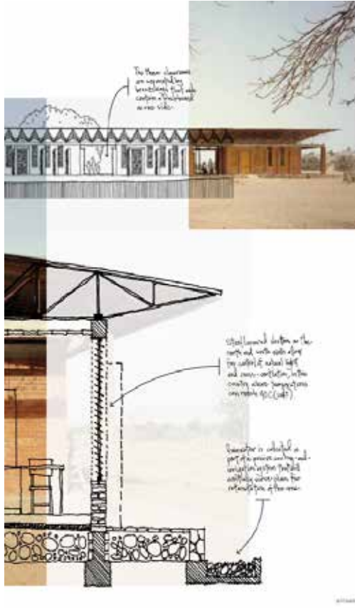
Resim 3.9. Gando İlköğretim Okulu çatı konstrüksiyonu (Url-17)
