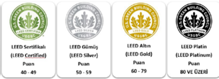
Şekil 2. LEED sertifikasyon sisteminin seviyeleri
