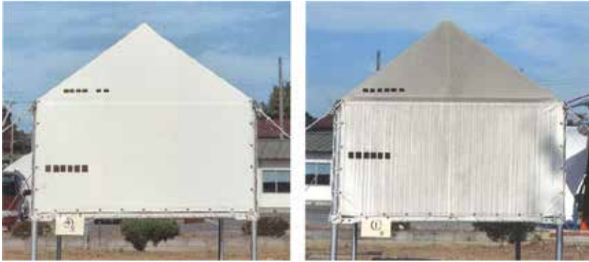
Şekil 11: TiO_2 kaplı (solda) ve PVC kaplı (sağda) beyaz membranların kirlenmelerinin karşılaştırılması (Leydecker, 2008)
