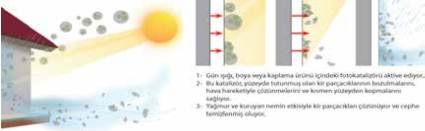
Şekil 10: Fotokatalitik özellikleri ile kendi kendini temizleyebilen cephe boya ve kaplamaları (URL-7)
