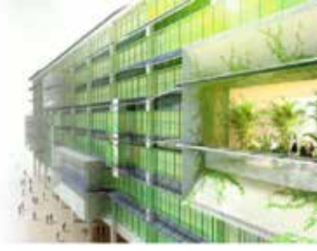
Şekil 11: Tübüler Fotobiyoreaktörlerin Bina Cephesinde Uygulanması (Kükdamar, 2015)
