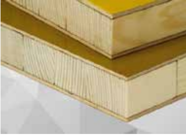
Şekil 9.a. Kontratabla ahşap yapı malzemesi (URL-8, 2017)
