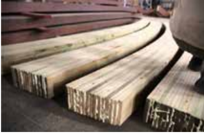
Şekil 17.a. GLULAM kirişlerin forma göre şekillendirilmesi (URL-19, 2017)
