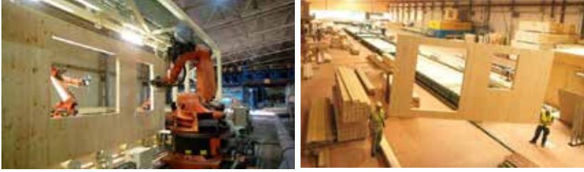
Şekil 39. Fabrika ortamında üretimi yapılan tabakalı ahşap panel elemanlar (URL-31, 2017)
