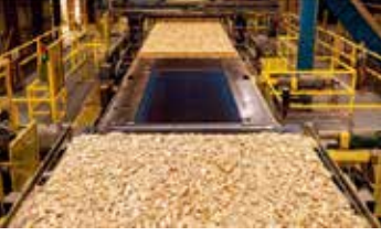
Şekil 14.c. LSL yongaların fabrika ortamında üretim aşaması (URL-16, 2017)
