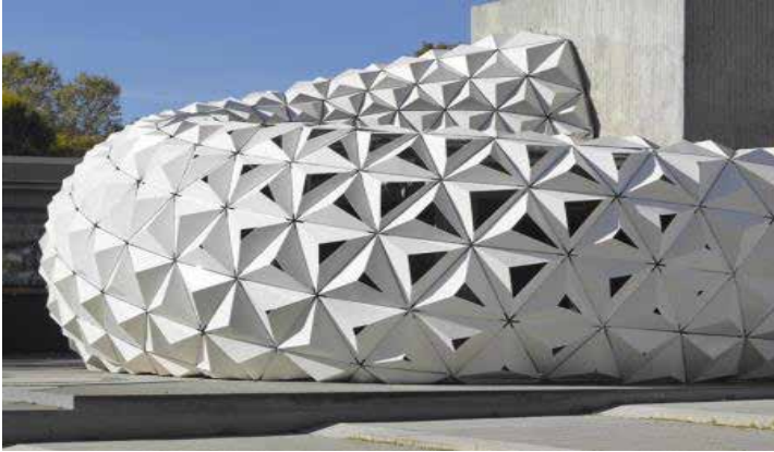
Şekil 5: Biyoplastik malzemeyle gerçekleştirilen ArboSkin Projesi (Url-2)
