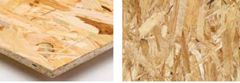
Şekil 10. Yönlendirilmiş yonga levha-OSB görünümü (URL-9, 2017)
