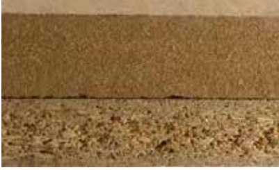
Şekil 12.a. MDF ve OSB malzemelerin yoğunluk karşılaştırması (URL-13, 2017)
