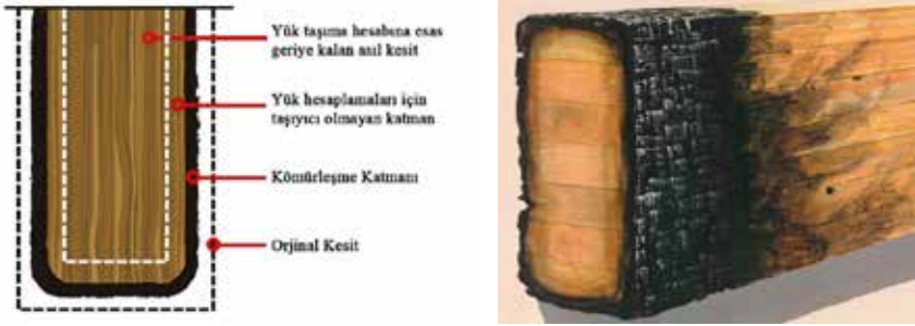
Şekil 2. Ahşap yapı malzemesinin yangın karşısındaki davranışı (White & Woeste, 2013)
