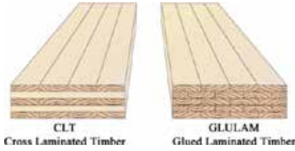
Şekil 19.a. CLT ve GLULAM elemanların oluşum farkları (Karacabeyli & Douglas, 2013)
