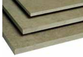
Şekil 12.b. MDF malzemenin yüzey ve kenar detayları (URL-14, 2017)
