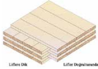
Şekil 19.b. CLT elemanların tabakalarının çapraz yapıştırılması (Karacabeyli & Douglas, 2013)
