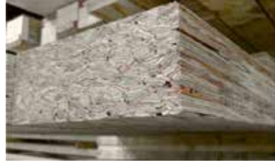
Şekil 13.b. PSL ahşabın kesit görünümü (URL-15, 2017)
