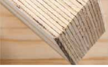
Şekil 15.a. LVL elemanın katmanlarını gösteren kesiti (URL-17, 2017)
