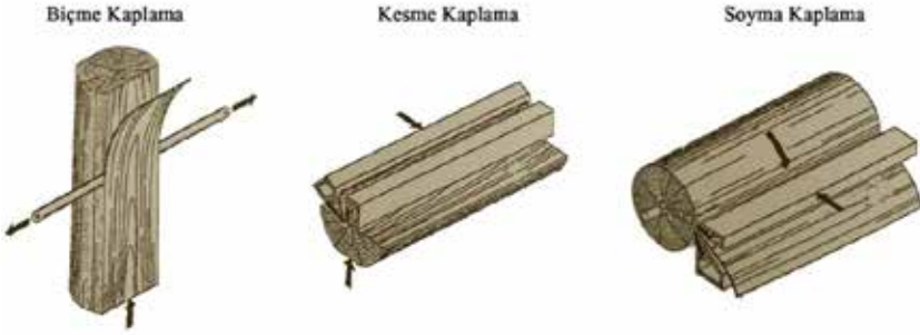
Şekil 6. Kaplama levhalarının elde edilme yöntemi (Örs & Keskin, 2008)
