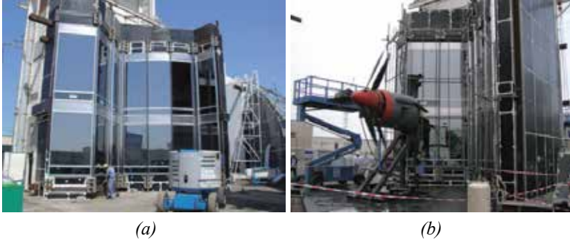
Resim 12. (a) Kule test modeli. (b) Dinamik su sızdırmazlık testi için kule test modeli (Weismantle ve diğerleri, 2007)
