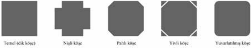
Şekil 3. Bina köşe geometrisinde iyileştirmeler (Günel ve Ilgın, 2010)
