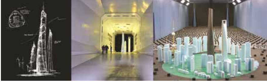
Şekil 18. Rüzgâr yüklerine karşı düşülen ilk form ve rüzgâr tüneli testleri [URL21]
