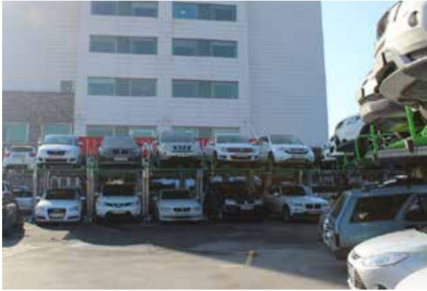
Şekil 6: Yarı Otomatik Otopark Sistemleri (Anonim, 2020)
