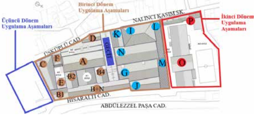
Şekil 4. Birinci, ikinci ve üçüncü dönem restorasyon aşamalarının hangi yapılarda yapıldığının 1998 yılına ait rölöve planı üzerinden gösterimi Birinci dönem uygulama aşamaları
