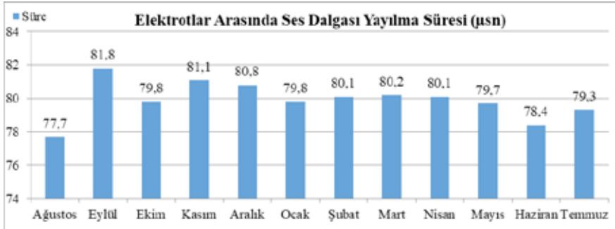
Şekil 15. Deva Hamamı Ağustos 2016-Temmuz 2017 tarihleri arasındaki elektrotlar arası ses dalgası yayılma süresi değişim grafiği
