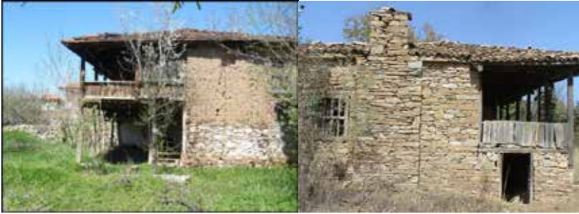
Resim 2.3. Tavas'ta şistlerden inşa edilmiş bir bađ evi ile ahşap ve kerpiçten inşa edilmiş bir bađ evi (Kadiođlu, 2010)
