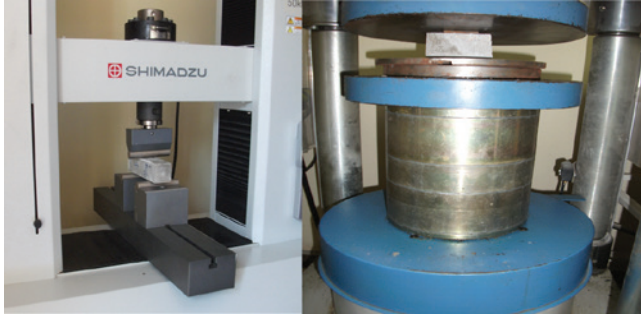
Şekil 5. Puzolanik aktivite deneyi betonlarda 40*40*160 mm numuneler uygulanan eğilme ve basınç dayanımı ölçümü görüntüleri
