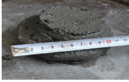
Şekil 3. Puzolanik aktivite deneyi betonlarda numune beton yayılma tablası görüntüsü
