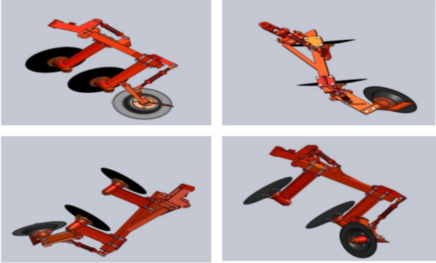
Şekil 7. Elektro-Hidrolik sistem entegrasyonu ile tasarlanan pulluk sisteminin model görseli
