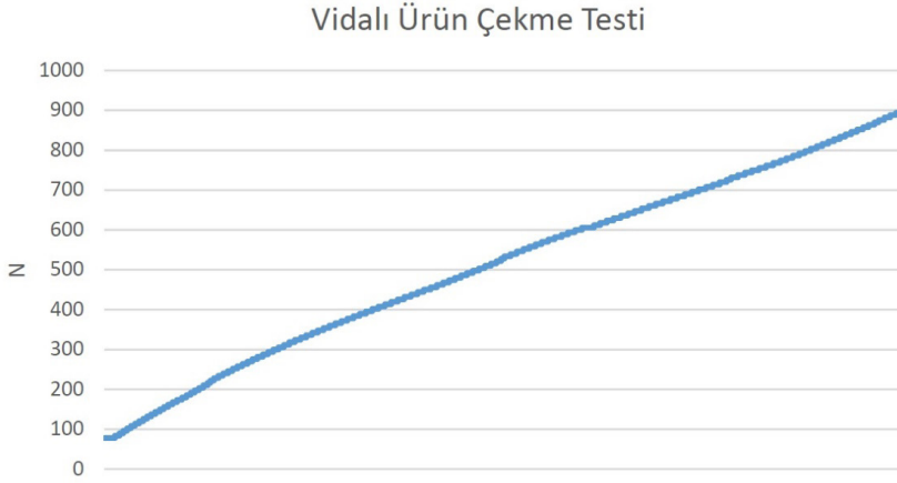
Şekil 10. Vidalı/perçinli tip kaynak yöntemi ile birleştirilen numunelere uygulanan çekme testi neticesinde alınan kuvvet/süre grafikleri
