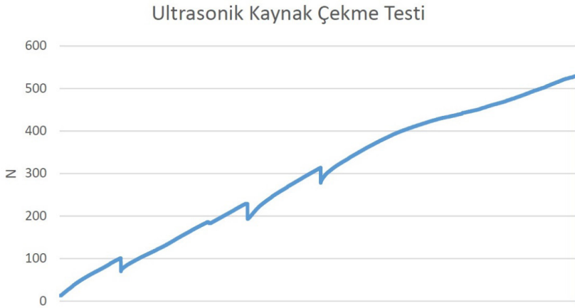
Şekil 11. Ultrasonik kaynak yöntemi ile birleştirilen numunelere uygulanan çekme testi neticesinde alınan kuvvet/süre grafikleri
