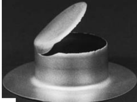
Şekil 6. Silindirik iş parçasında limit çekme oranının araştırılması sonucu ortaya çıkan hasar [21]
