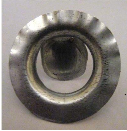
Şekil 7. Çekme oranının büyük olmasından dolayı parçada meydana gelen yırtılma [18]
