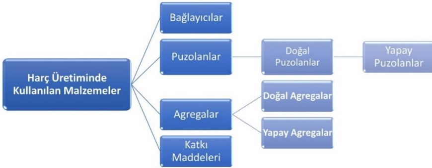
Şekil 1: Harçları oluşturan ana malzemeler
