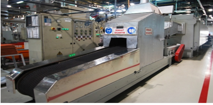
Şekil 12. Sinterleme fırını (Konveyörlü-bantlı sistem)
