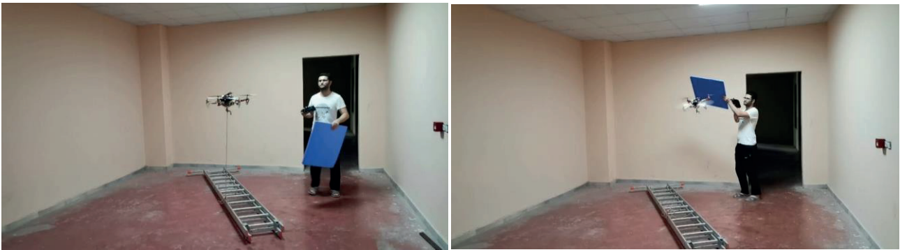
Şekil 16. Engelden Kaçan Drone Kapalı Alan Testi
