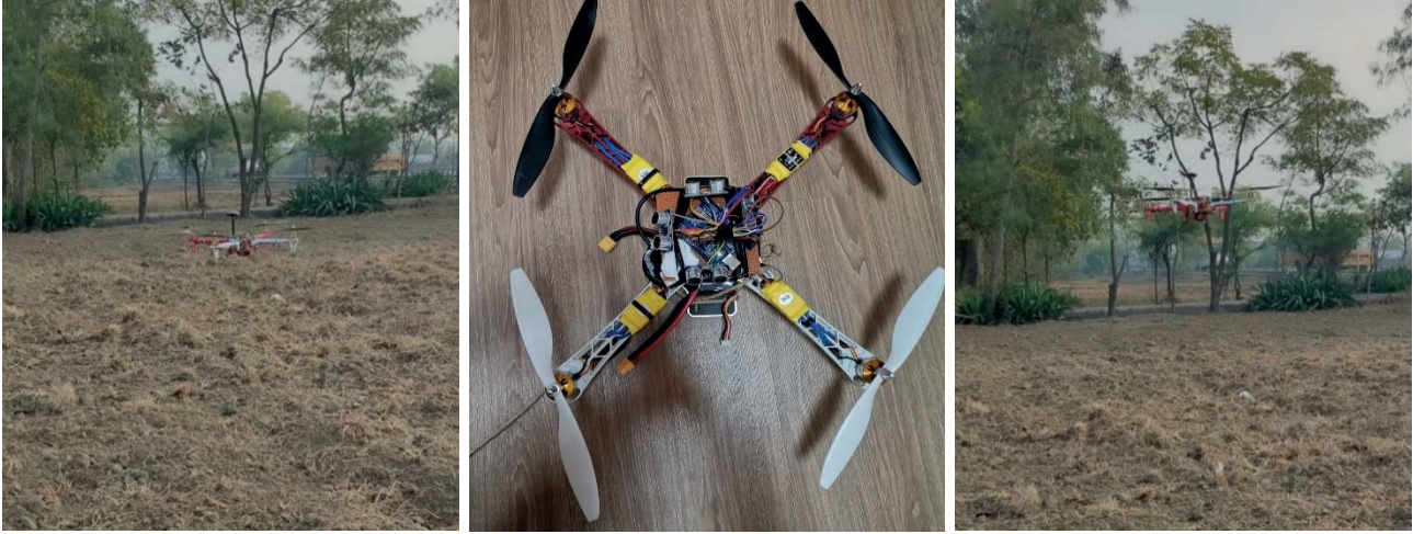
Şekil 17. Engelden Kaçan Drone Fiziksel Yapısı ve Açık Alan Testi
