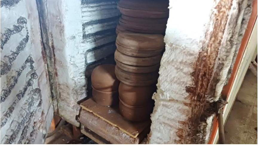
Görsel 3. Birbiri üstüne kapatılan ii talařlı kapların elektrikli fırına yerleřtirilmesi.
