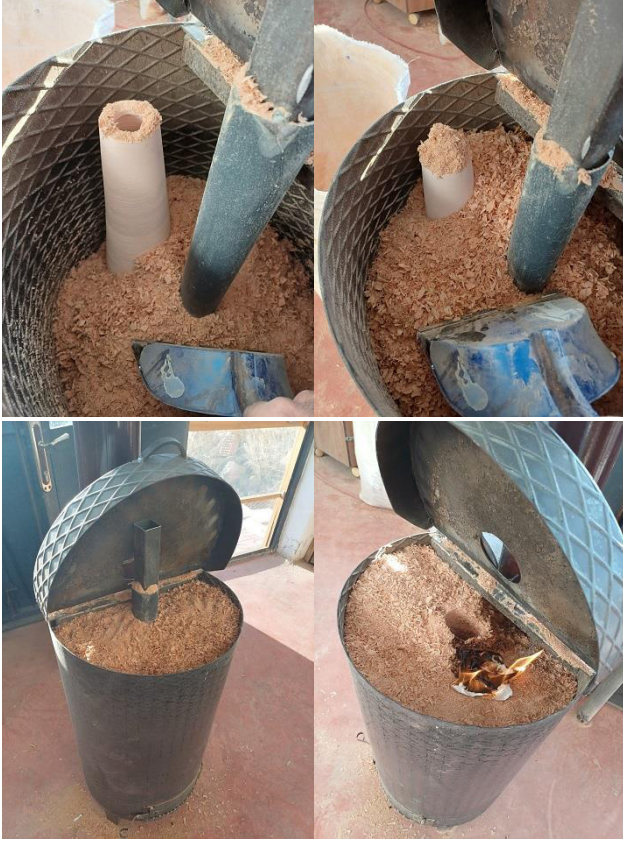
Grsel 7. Talař basma iřlemi, sobanın tamamen doldurulması ve sobanın tutuřturulması.
