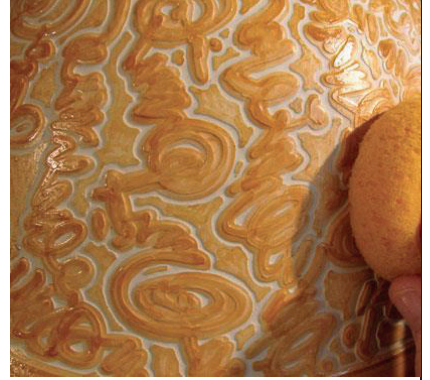
Görsel 6: Parçanın kurutulduktan sonra nemli süngerle silinmeye devam edilmesi aşaması
