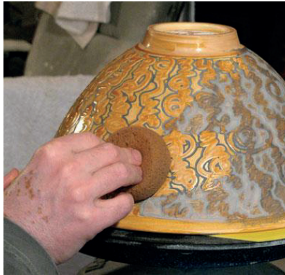
Görsel 8: Gomalak uygulanan yüzey üzerinden siyah astarın sünger yardımıyla silinmesi
