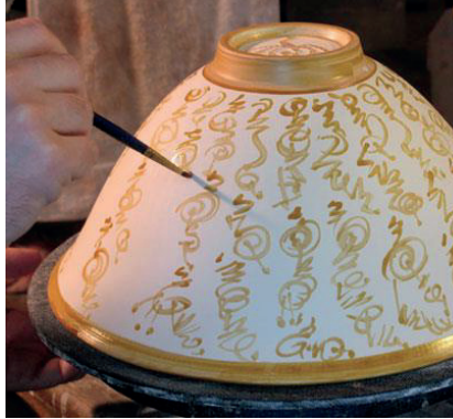
Görsel 2: Desenin ortaya çıkmasını sağlayacak ilk gomalak katmanının seramik yüzeye fırça ile uygulanması
