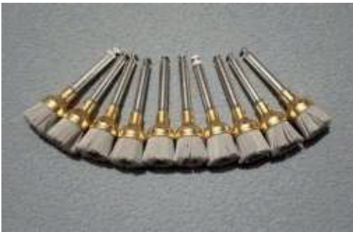
Şekil 6 : Aşındırıcı emdirilmiş fırçalar ve keçeler
