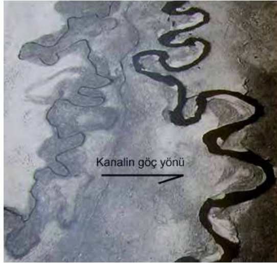
Şekil 9: (A, B) Tektonik çarpılmanın sebep olduğu yatak göçü (Killer ve Pinter, 2002).
