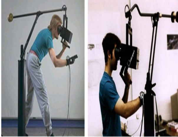
Görsel 1. Boom (binoküler omni alıştırma monitör) (Onyesolu ve Eze, 2011: 55)
