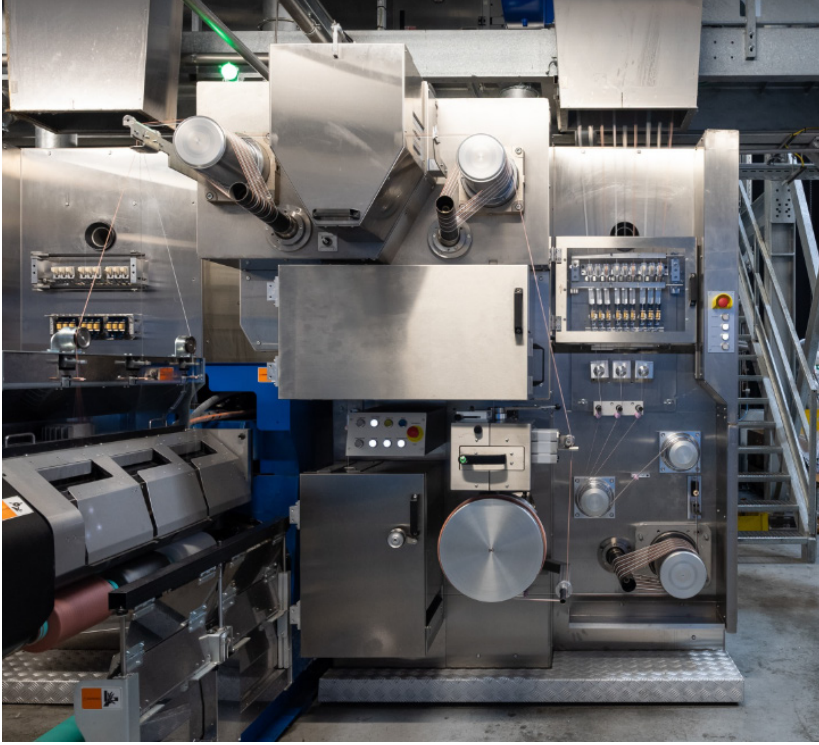
Şekil 7. BCF makinesinin alt kısmı: spin-finish, 1.çekim, 2.çekim, tekstüre, soğutma tamburu, puntalama ve sarım bölgeleri [7]
