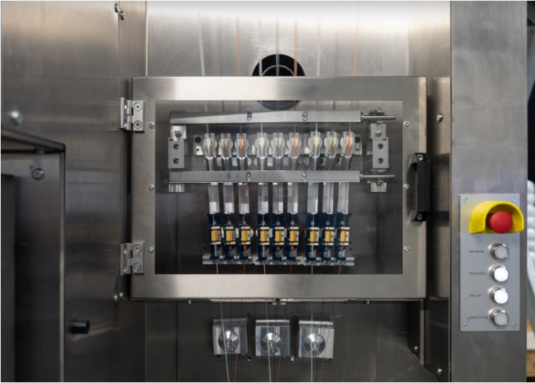
Şekil 6. Spin-finish uygulama bölgesi [7]
