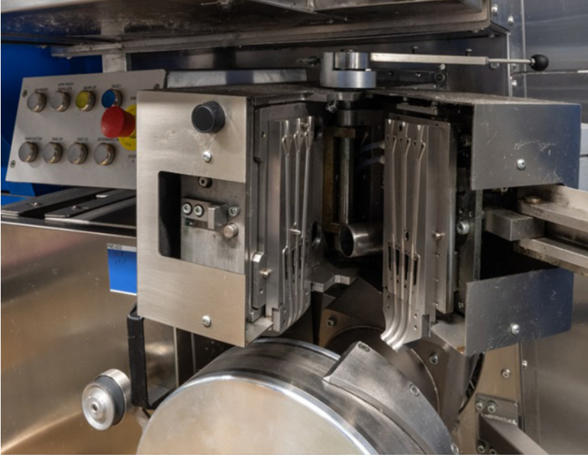
Şekil 10. Tekstüre ünitesi ve soğutma tamburu [7]
