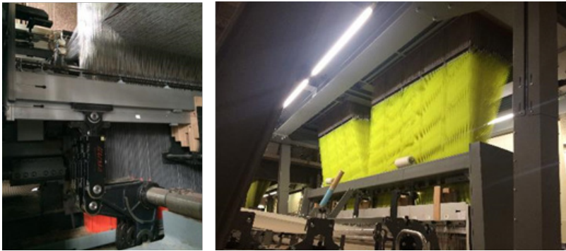
Şekil 8. Armür ve jakar mekanizmaları
