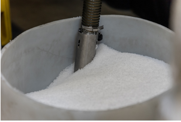
Şekil 2. Polimer cips (dozajlama) [7]
