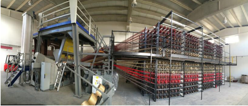
Şekil 4. Wilton tipi halı dokuma makinesi
