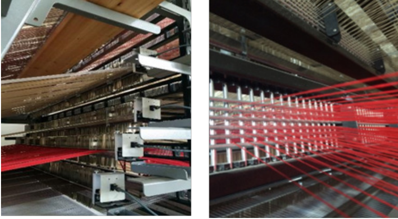
Şekil 7. Cağlıktaki hav süzgeçleri
