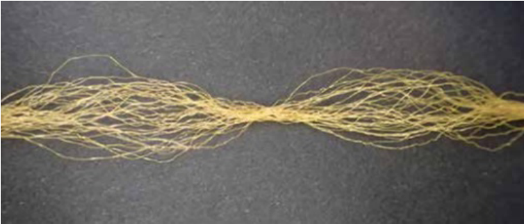
Şekil 11. İplikte punta noktası [6]
