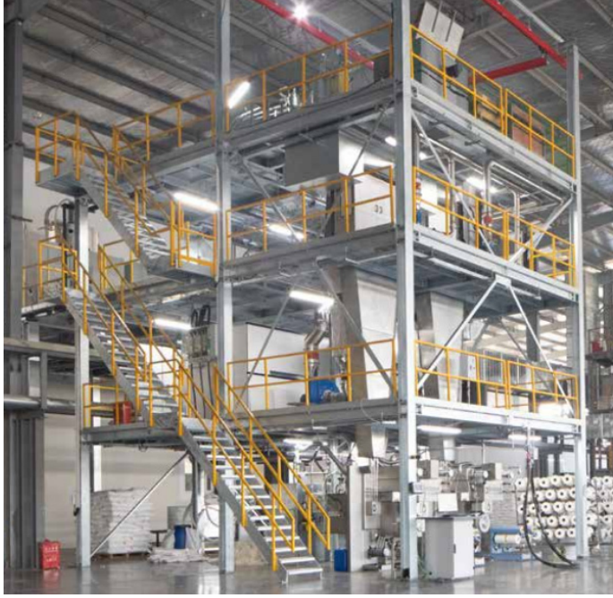
Őekil 1. BCF iplik üretim makinesi [6]
