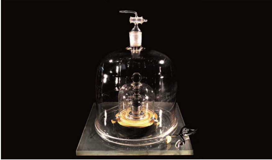
Resim 1. Büyük K (Kilogram, İridyum ve platin alaşımı metal silindir) Ağırlıklar ve Ölçüler Uluslararası Bürosu, Paris, Fransa
