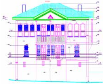
Şekil 4. Ayşe Sezgin Evi'nin güney cephesi ve rölöve güney cephesi görünüşü.
