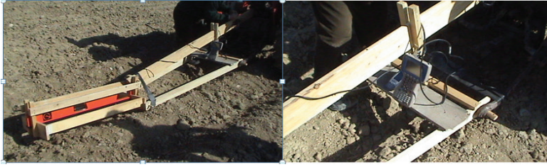
Şekil 11. Arazide Elektriksel iletkenlik ölçümü için oluşturulmuş sistem
