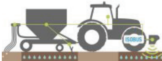
Şekil 10. Gerçek zamanlı sensör destekli ekim kontrolü
