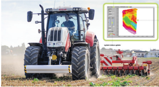
Şekil 9. Toprak işleme makinaları ile ISOBUS tabanlı ÜHT uygulaması
