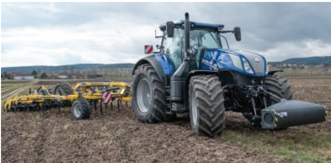
Şekil 8. Üst Toprak Haritalandırıcısı (ÜTH) ile birlikte kullanılan toprak işleme makinası
