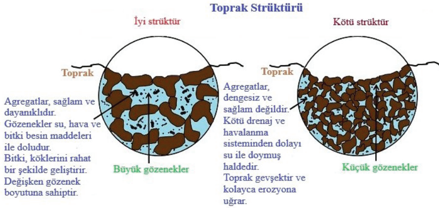
Figure 5. İyi ve kötü strüktürde toprakta agregat oluşumu, gözeneklilik, hava ve suyun dolaşımı (Url, 4'ten değiştirilerek).
