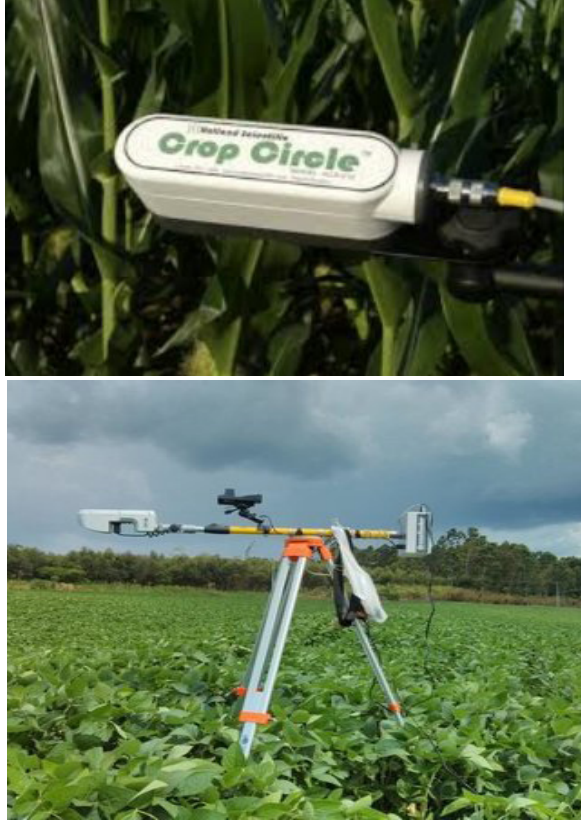
Şekil 2. El tipi hareketli optik NDVI ölçüm cihazları
