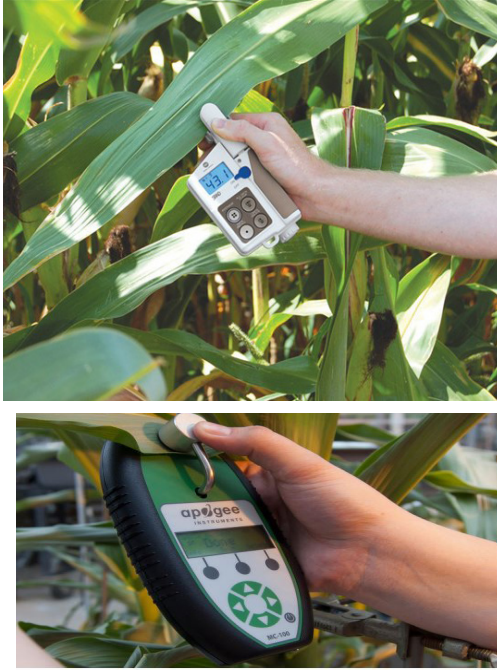
Şekil 1. Yakın temashlı optik yapraktan klorofil ölçme (Spad ve apogee)
