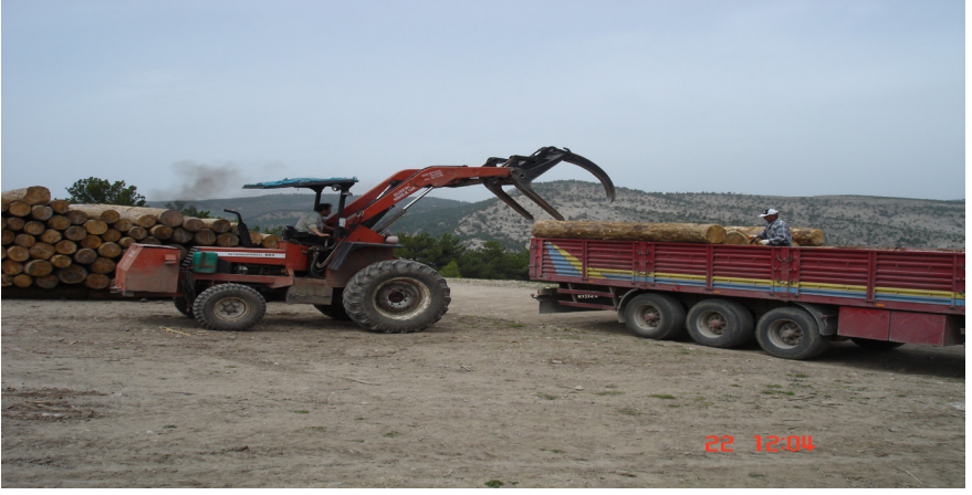
Şekil 1. Tarım traktörüne monteli yükleme makinesi.
