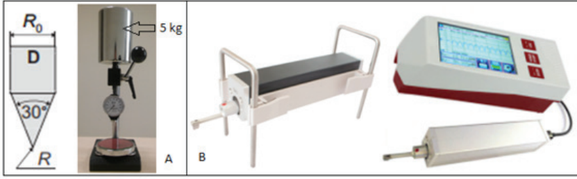
Şekil 1. Shore - D sertlik cihazı ve yapısı (Grellmann ve Seidler 2014) (A) ve yüzey pürüzlülüğü test cihazı (B)
