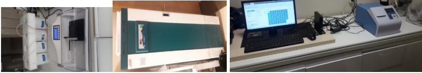
Resim 3. Mikropate yıkama cihazı, etüv ve bilgisayarlı mikropate reader.
