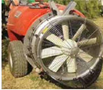
Şekil 1. Standart tip dairesel püskürtme çubuklu yardımcı hava akımlı bahçe pülverizatörünün şematik üniteleri ve arkadan görünüşü
