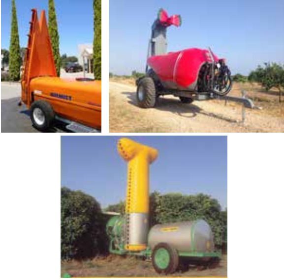
Şekil 2. Kuleli tip püskürtme ünitesine sahip yardımcı hava akımlı bahçe pülverizatör modelleri
