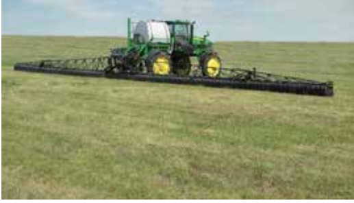
Şekil 1/a. Püskürtme kolunu tamamen örten koruyucu sistem
