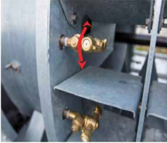
Şekil 9. Memelerin bağlantı noktasından ağaç tacı yüksekliğine göre yönlendirilme seçeneği
