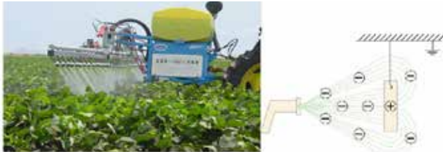
Şekil 5. Elektrostatik püskürtme ve temel prensip
