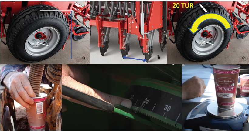
Şekil 7. Yatay tohum dağılımında (ekim normu) kalibrasyon
