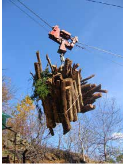
Şekil 8. Vinçli hava hattı ile ster halinde demet halinde sanayi odununun taşınması
