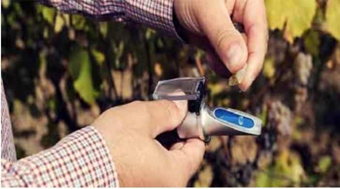
Şekil 2. El refraktometresiyle Brix derecesinin kontrolü (Anonim, 2020d)
