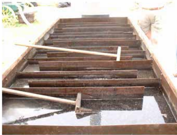
Şekil 5. Özsu buharlaştırma tavası
