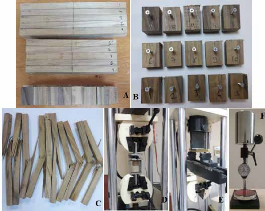
Şekil 1. Yoğunluk, şok direnci ve eğilme direnci testleri için hazırlanmış deney örneklerine ait görüntüleri (A), vida tutma kapasitesi testine ait deney örnekleri (B), şok direnci testi sonrası deney örneklerinin görüntüsü (C), vida tutma kapasitesine ait testin yapılışı (D), eğilme direnci testinin yapılışı (E) ve shoremeter cihazı (F)
