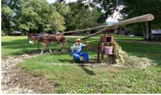
Şekil 3. Beygir gücüyle çalışan sıkıştırıcı mil sistemi (Anonim, 2020e)
