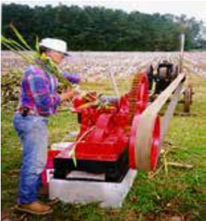
Şekil 4. Traktör beygir gücüyle ve elektrik motoruyla çalışan sıkıştırıcı mil sistemi (Anonim, 2008e)
