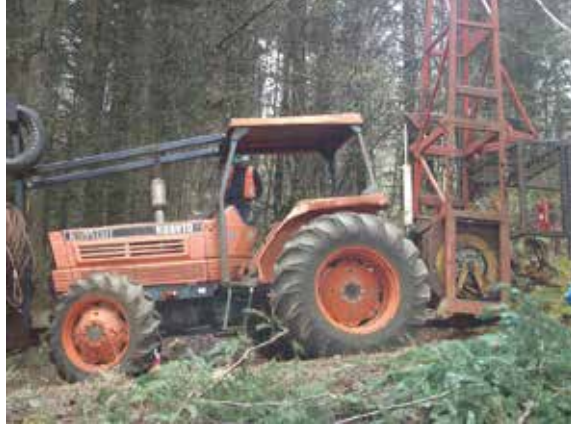
Şekil 2. Traktöre monteli Koller vinçli hava hattı (Foto: T.Öztürk)
