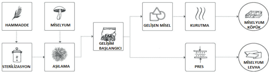
Şekil 2. Miselyum kompozit malzeme üretim aşamaları
