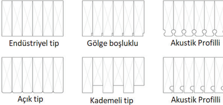
Şekil 7. Çivili tabakalanmış kerestede yüzey görünüşleri (Structure Craft, 2021).
