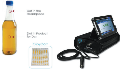
Şekil 8. O2xyDot sensörü ve optik okuyucu
