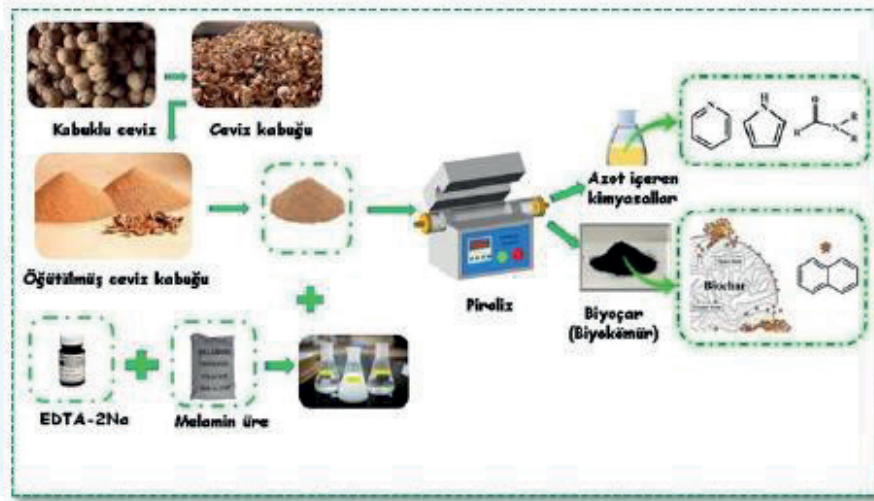
Şekil 2. Ceviz kabuğundan azot içeren kimyasallar ve biyoçar üretim akış diyagramı (Wang ve ark., 2022).
